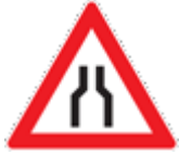
Zeichen 120 Verengte Fahrbahn
